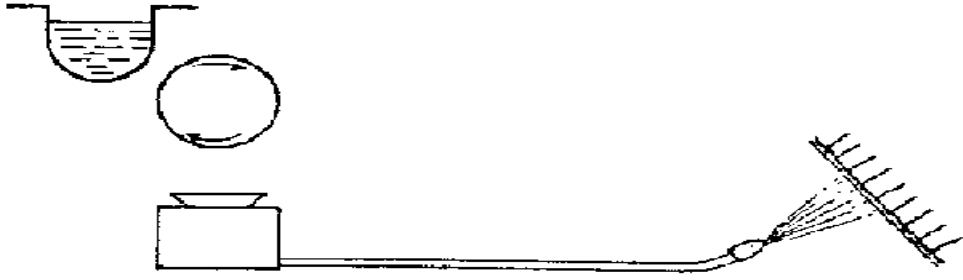
شكل (3): رسم توضيحي لتقنية رش المونة الإسمنتية بالأسلوب الرطب
